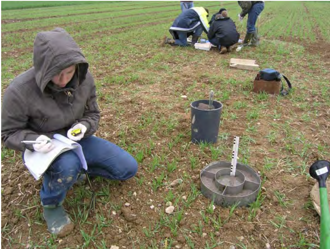
Abbildung 5-1: Studierende der FH Bingen bei der Messung der Wasserinfiltration mit dem Doppelring-Infiltrometer auf dem Standort Dichtelbach im Hunsrück
