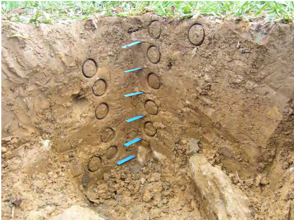
Abbildung 6-2: Bodenprofil in Welschbillig im Frühjahr 2008 mit Stechringen in der Profilwand bis in eine Tiefe von 60 cm; massiver Kalkstein kommt im Unterboden zu Tage
