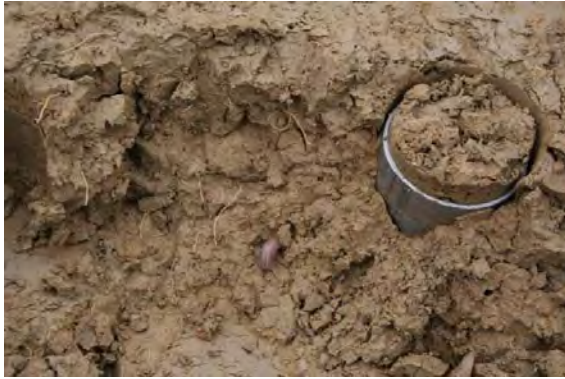
Abbildung 7-4: Probenahme mit Stechzylindern für bodenphysikalische Laboruntersuchungen am Standort Welschbillig
